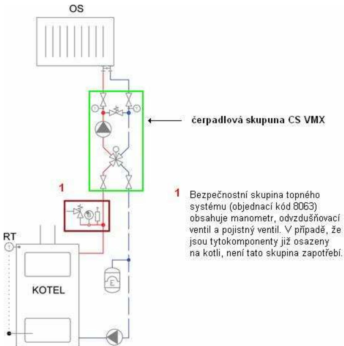
1 Bezpečnostní skupina topného systému (objednací kód 8063) obsahuje manometr, odvzdušňovací ventil a pojistný ventil. V případě, že jsou tyto komponenty již osazeny na kotli, není tato skupina zapotřebí.
