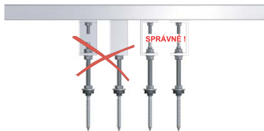
f) Šroub do sřešní krytiny a jeho správne přichycení k „H“ profilu
